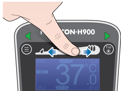
Figura 12. Ajuste do gradiente de temperatura
