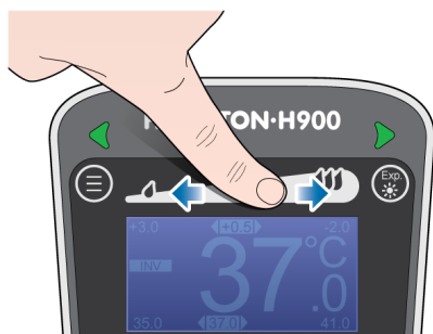
Figura 12. Regolazione del gradiente di temperatura
