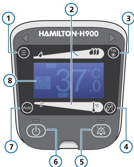
Рисунок 3. Увлажнитель HAMILTON-H900. Элементы управления на передней панели
