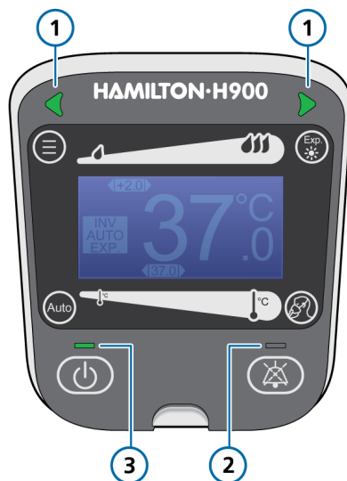
Рисунок 4. Увлажнитель HAMILTON-H900. Индикаторы состояния на передней панели
