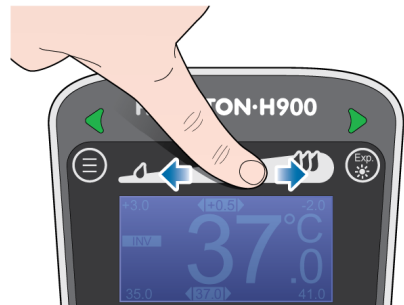
Figura 12. Ajustar el gradiente de temperatura
