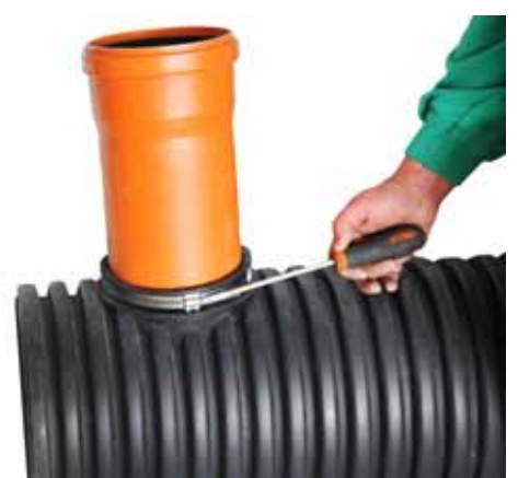
6. Se fixează colierul din plastic și se strânge la 6 Nm
