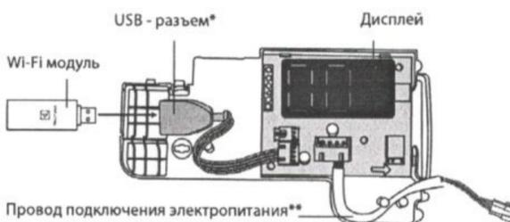
\* Разъем для подключения Wi-Fi модуля
