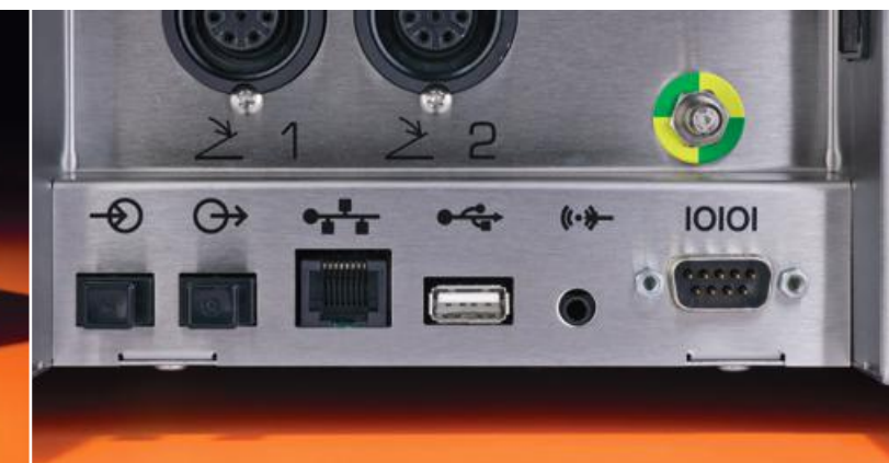
Продуманный интерфейс: USB-порт и сетевой разъем - для решений сегодня и в будущем
