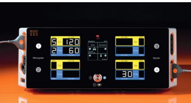
Наглядно: каждый подключенный разъем, на изображении это верхний левый и нижний правый разъемы, соотносен с определенным квадратом экрана
