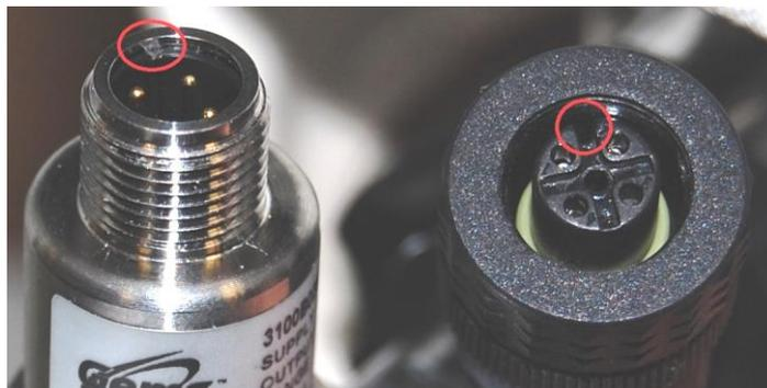
**DETROMPEUR SUR CONNECTEURS DU CAPTEUR DE PRESSION**
