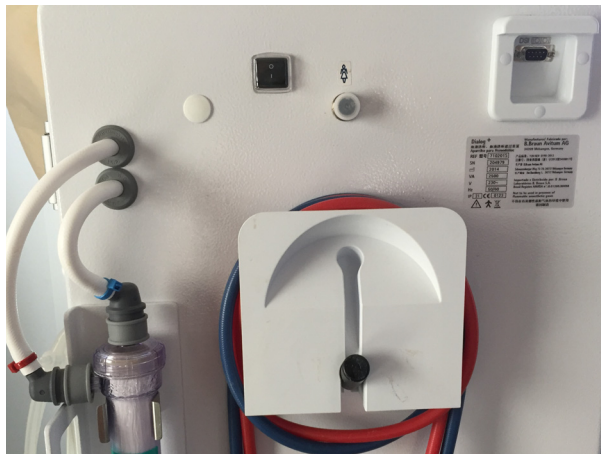
Imaginea 4-1 Depozitarea cablurilor și a tuburilor
