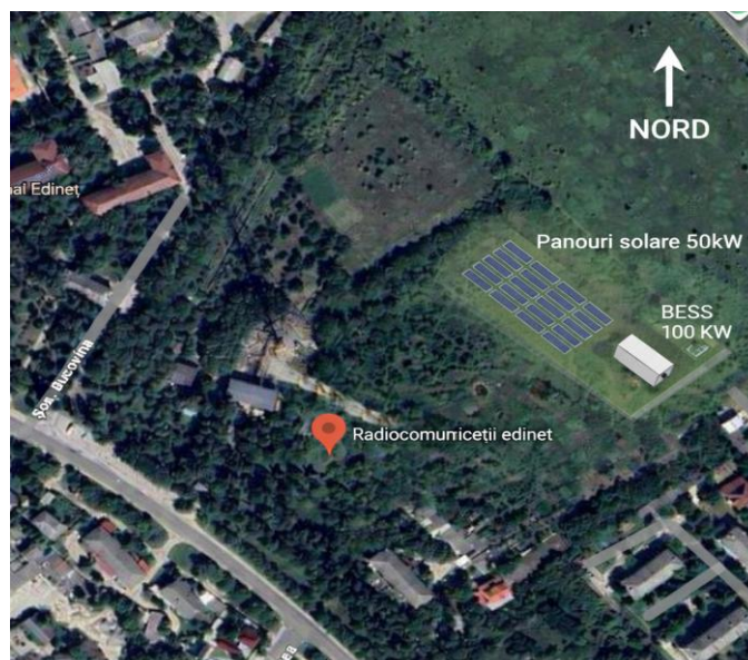
Fig. 2. Prezentarea aranjamentelor panourilor fotovoltaice
