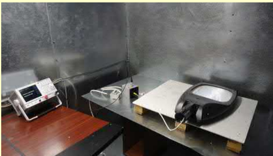
Modul de amplasare al aparatului supus incercarii pentru domeniul 30-300MHz
