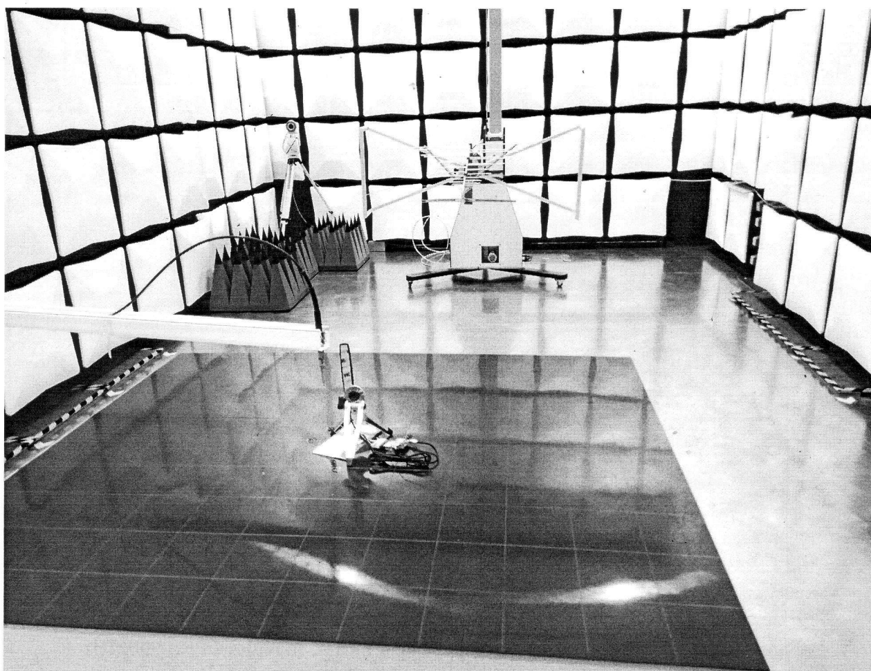
Figura 2.2. Măsurarea emisiilor radiate la frecvențe până la 1 GHz
