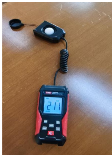
Figura 4. Rezultatele măsurării iluminării cu un luxmetru
