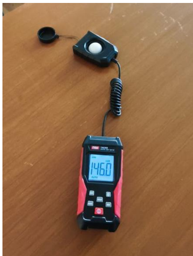
Figura 4. Rezultatele măsurării iluminării cu un luxmetru
