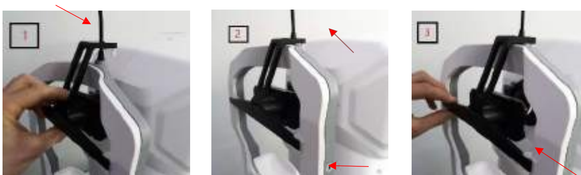
Figura 439. Montarea instrumentului de calibrare REVO
