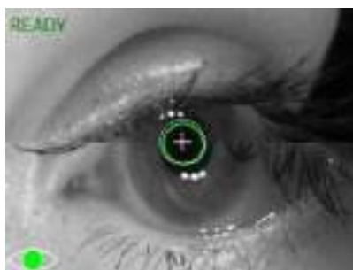
Figura 33. Poziția capului de măsurare corect aliniat
