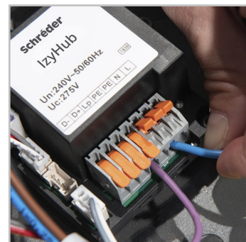
Modulul IzyHub, elimină posibilitatea apariției erorilor de conectare, ușurează conexiunea electrică la instalare și în timpul operațiunilor de mentenanță.
