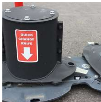
Sistemul de schimbare momentană a cuțitelor Quick Change
