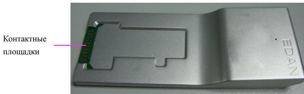
Рис. 2-4. Внешний электронный симулятор
