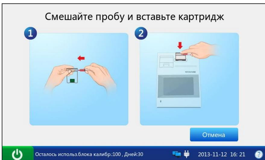
Рис. 6-5. Перемешивание контролей и вставка картриджа
