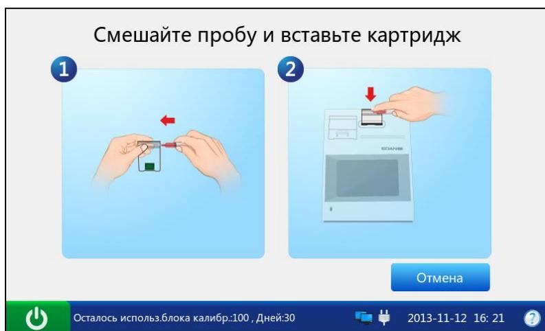
Рис. 6-31. Перемешивание контролей верификации калибровки и вставка картриджа
