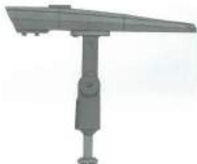
Fig. 3 – Modelul 3D al corpului de iluminat în poziția de încercare longitudinal orizontal ( \alpha_x = 0^\circ și \beta_y = 0^\circ )
