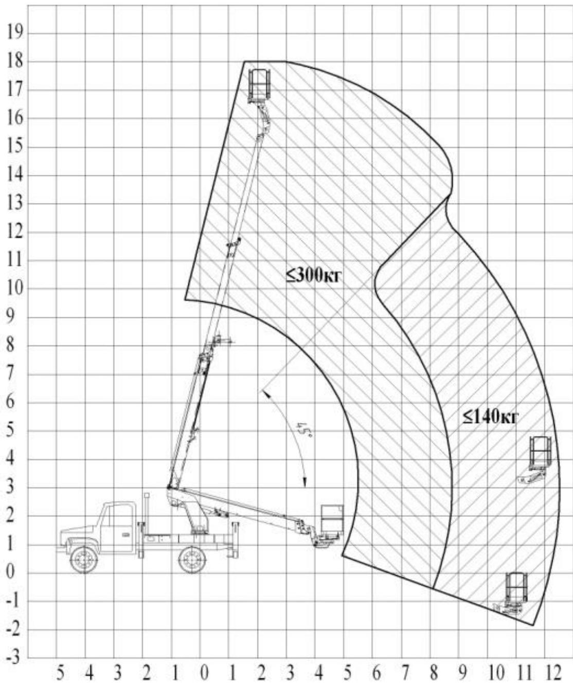
**Рисунок – Грузовысотная характеристика подъемника**
