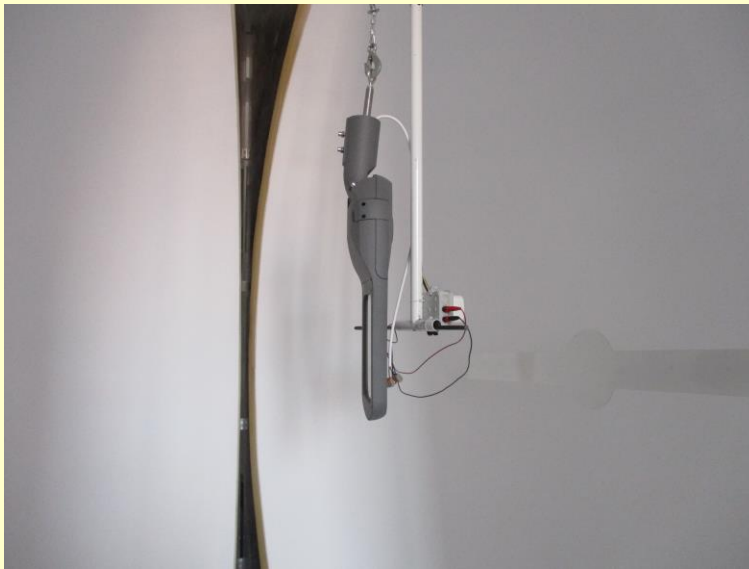
Modul de amplasare in sfera de integrare al aparatului supus incercarii
