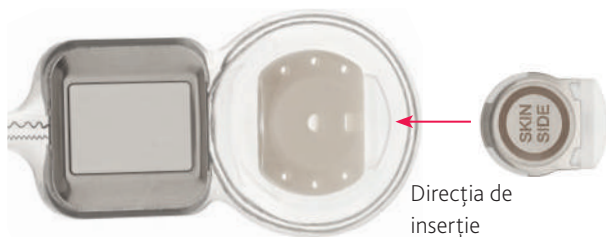
Figura 27: Direcția de inserție a casetei cu magnet de schimb
