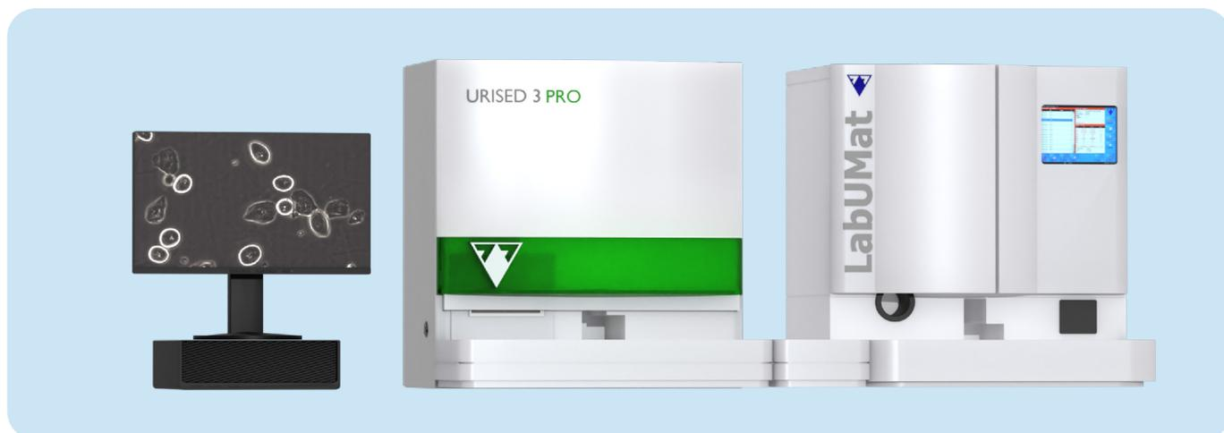
LabUMat 2 – автоматический анализатор физико-химических свойств мочи, использующий метод отражательной фотометрии и прямое измерение физических параметров.
