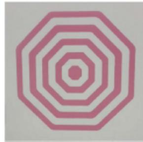
Il foglio indicatore non è virato al centro oppure non è virato completamente, indicando che l'autoclave non funziona correttamente ed è quindi necessario l'intervento dell'assistenza tecnica.
