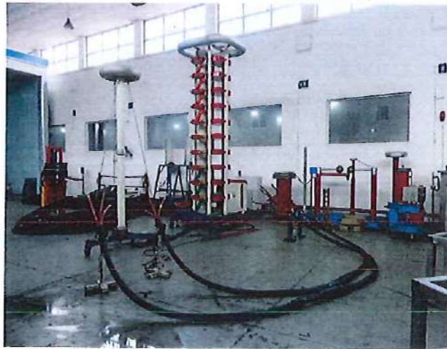
E3: 冲击电压试验 Impulse voltage test
