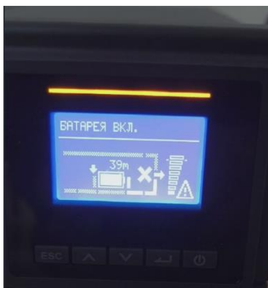
Fig.2. Timpul de autonomie cand USG-ul este conectat la sursa UPS Model ITY3-TW010B.
