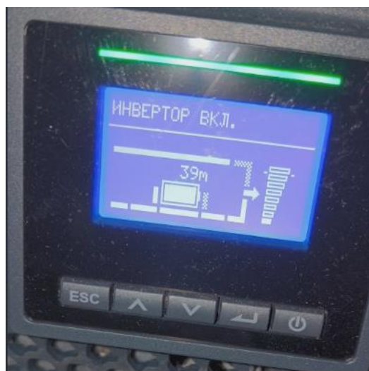
Fig.1. Timpul de autonomie UPS
