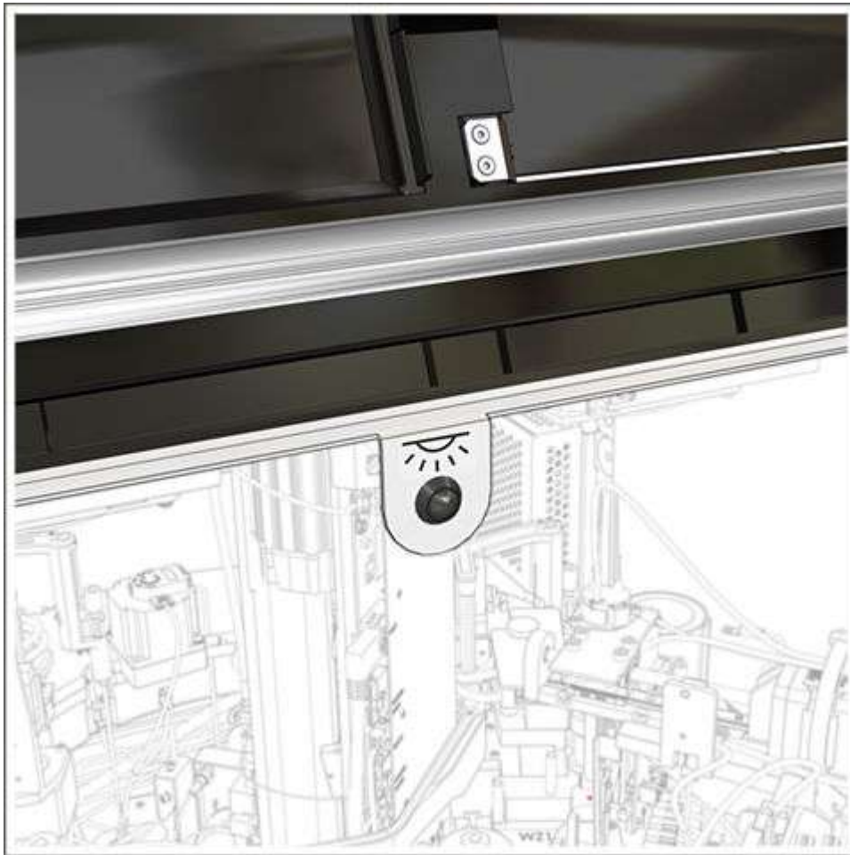
Figură 25: Buton pentru luminile de interior ale centrului de procesare
