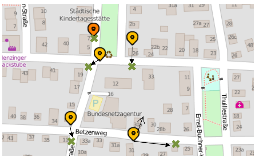
Bild 3-4: Vergleich der automatisch erzeugten (gelbe Punkte) und tatsächlichen Messpositionen (grüne Kreuze)
