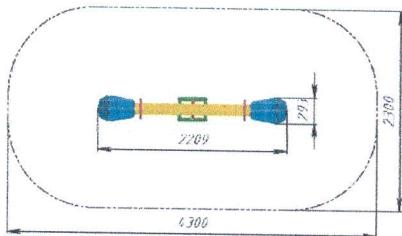
Balansoar cu două locuri destinat copiilor cu vîrstă de la 3 ani. Componente: constructia este constituita din suportul de legănare cu elemente de amortizare din cauciuc, scaune si manere, baza metalica.
