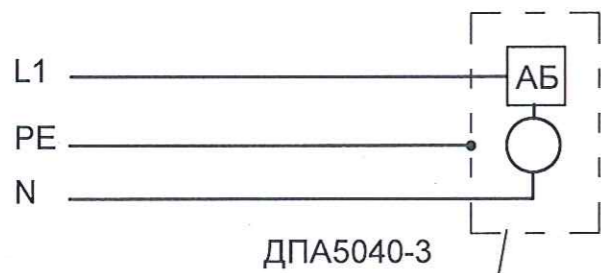
Схема подключения светильников со встроенными аккумуляторами
