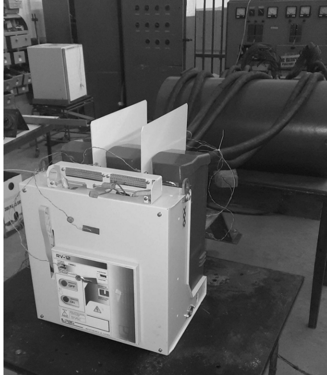
Рисунок 10.3 – Вимикач при випробуваннях на перевищення температури
