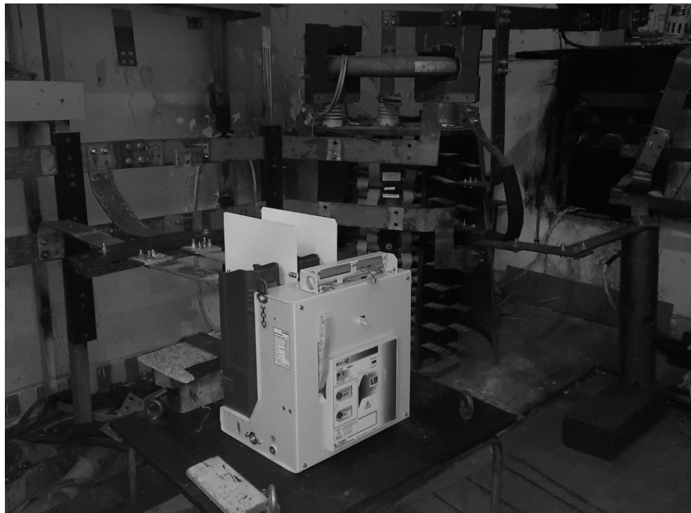
Рисунок 10.4 – Вимикач на стенді електродинамічних випробувань
