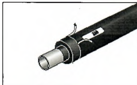
Приклад ізолювання торців трубопроводу
