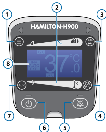
Figura 3. Umidificador HAMILTON-H900, controles do painel frontal
