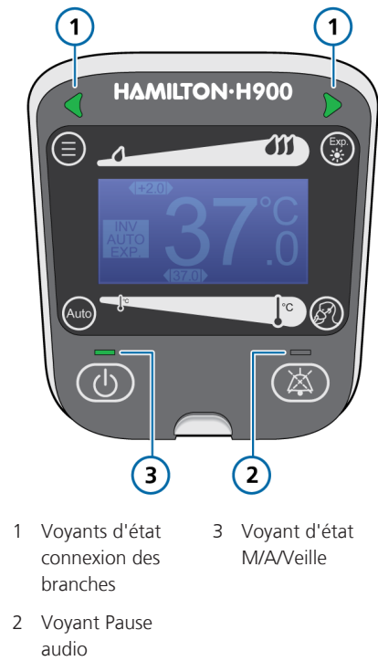
Figure 4. Humidificateur HAMILTON-H900, voyants d'état du panneau avant
