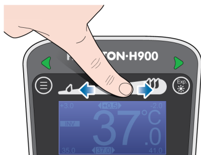
Figura 12. Regolazione del gradiente di temperatura
