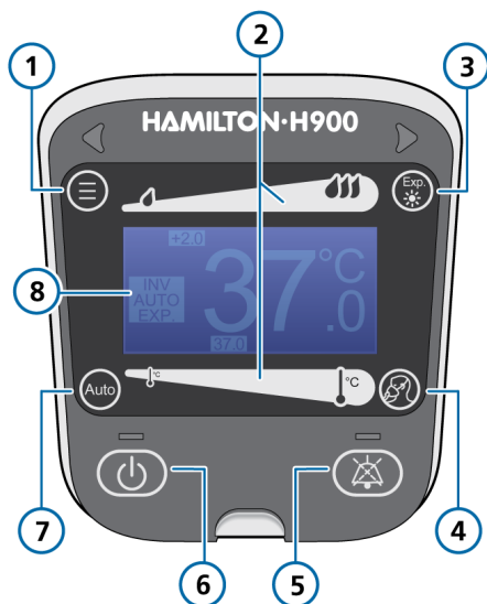
Figura 3. Humidificador HAMILTON-H900, controles del panel frontal
