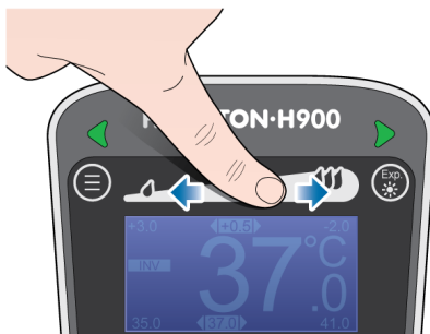
Figure 12. Réglage du gradient de température
