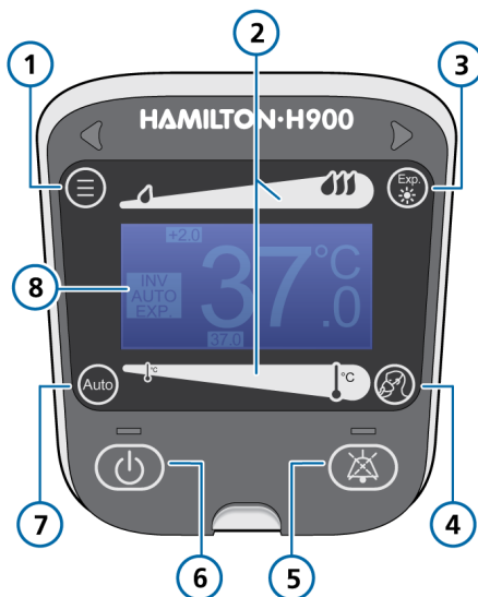
Abbildung 3. HAMILTON-H900 Befeuchter, Elemente am Bedienfeld
