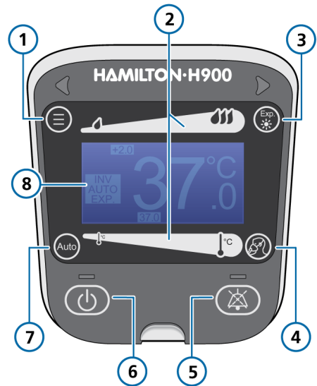
Figure 3. Humidificateur HAMILTON-H900, réglages du panneau avant
