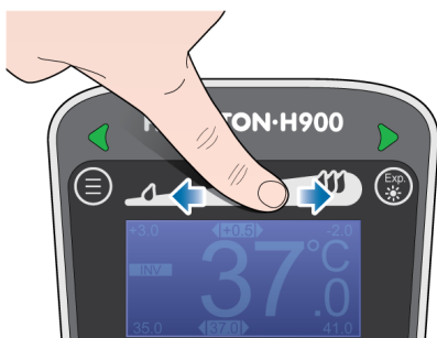
Рисунок 12. Регулировка температурного градиента
