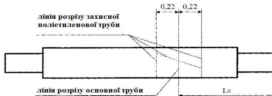
Рис. 16. Подготовка к разрезанию трубы
