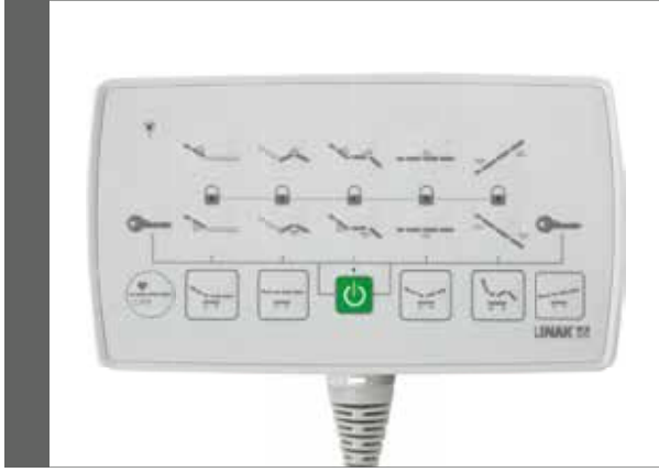
HEMŞİRE KONTROL ÜNİTESİ / NURSE CONTROL UNIT
