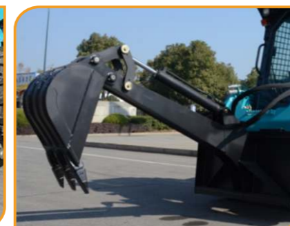
Braț de excavare
