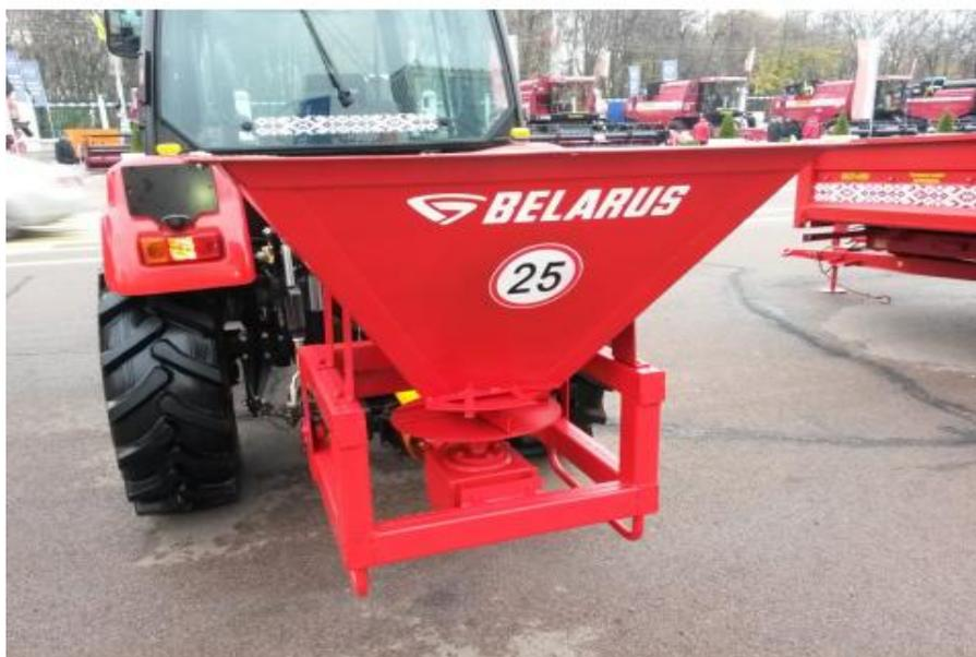
предназначен для разбрасывания песка и песчаных солевых смесей по автодорогам, тротуарам, улицам, производственным территориям. Разбрасываемый материал должен быть сыпучим, влажностью не более 15% без комков и камней. Допускается наличие комков диаметром не более 15 мм до 5% от общей массы.
