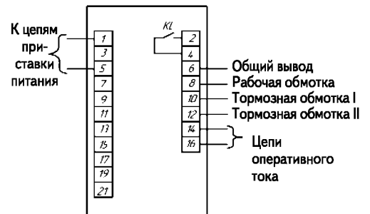
Рисунок 5 — Схема электрическая подключение реле типа РСТ 23-6.
