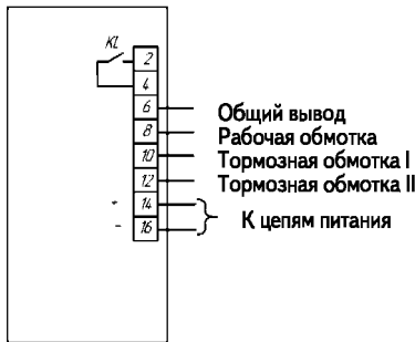
Рисунок 3 — Схема электрическая подключения реле типа РСТ 23-1, РСТ 23-2.
