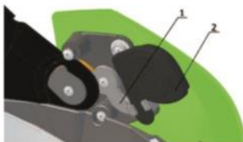
Fig. 8 Placă de fixare cu sistem de comunicare fix. 1. Suport sistem de comunicare; 2. Difuzor
