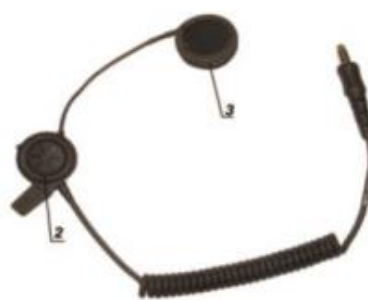
Fig. 6 Sistem de comunicare HC-1 de la SAVOX
