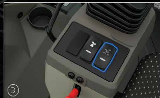
3 Кнопка переводного механизма для функции обратной лопаты или погрузчика
