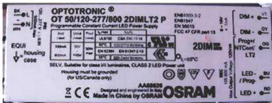
Zdroj s předřadníkem - Source and LED controller
