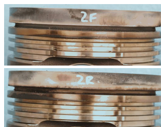
Минимальные отложения на поршнях по результатам 500-часового специального испытания масла Cat DEO-ULS на выносливость
