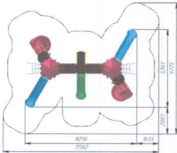
Construcția este constituită din 2 turnuri hexagonale cu acoperis, turn simplu, 2 tobogane mare drept, tobogan drept, 2 tobogane spirale, 2 balconuri cu balustrade, scara, 2 podețuri cu balustrade de tip "val" cu elemente decorative, 2 masute cu scaune incorporate.
