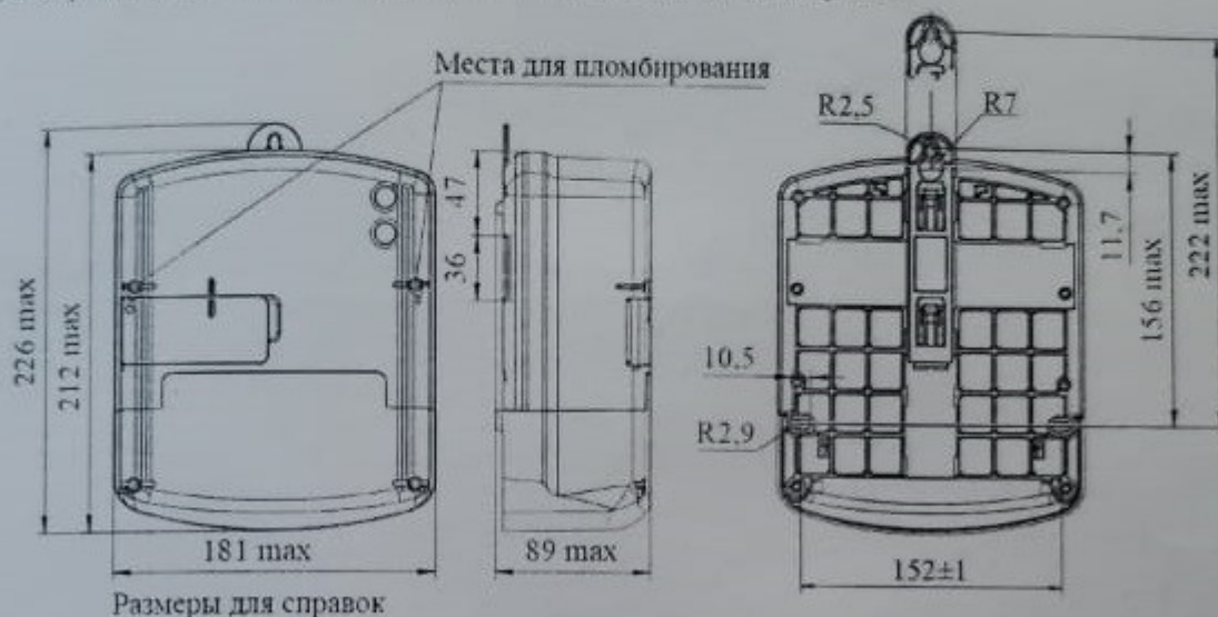
Рисунок 5. Габаритные и установочные размеры счетчика
