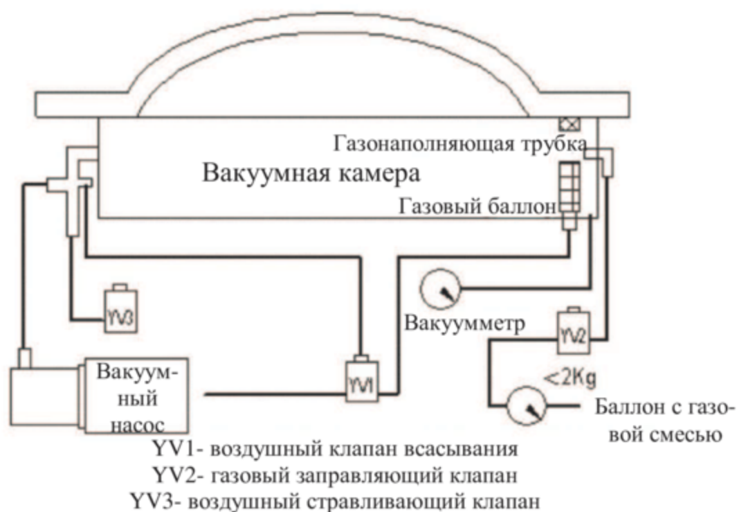
Схема вакуумного упаковщика с системой газации
