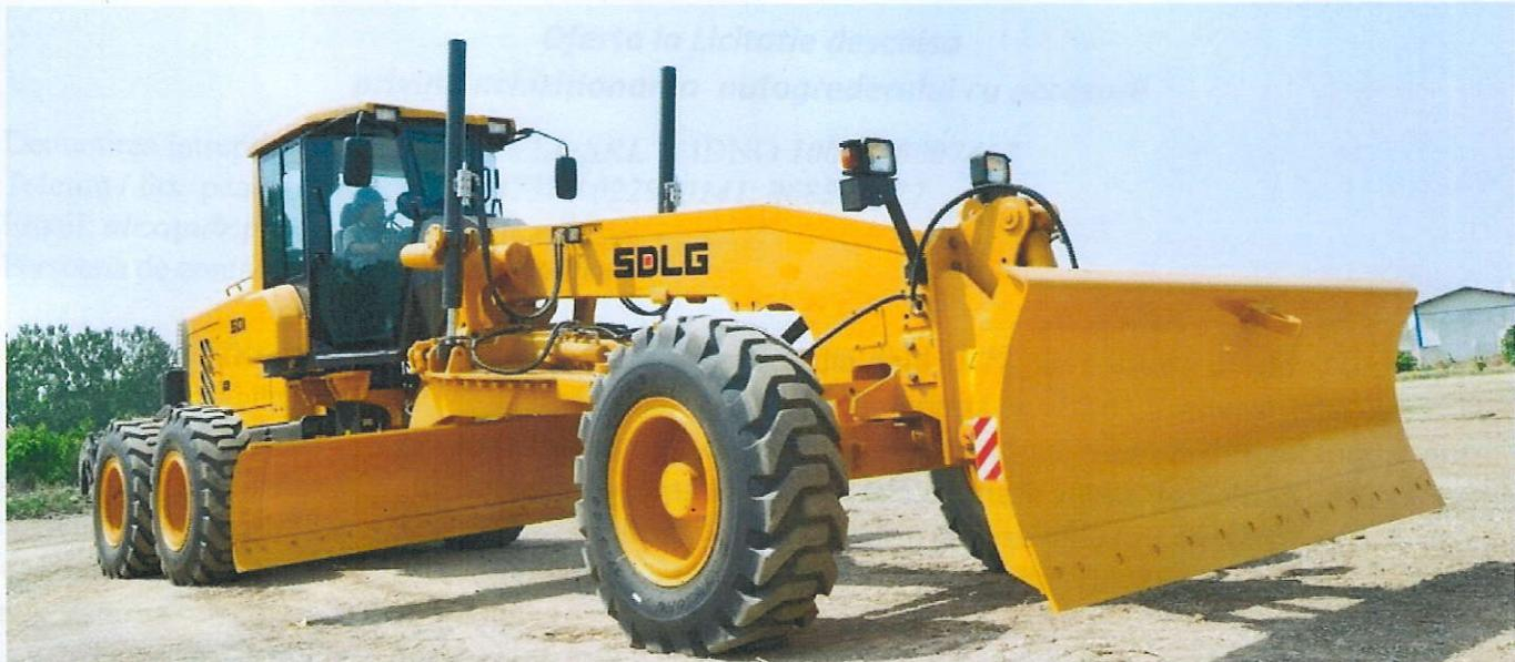
În cadrul unei contractări cu aer condiționat are o visibilitate largă, comenziile echipamentului de lucru sunt aranjate în conformitate cu principalele ergonomicice, ceea ce reduce oboseliile operatorilor.
