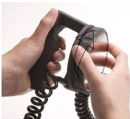
Fig. 15 Blocarea padelelor pentru adulți pe padelele pentru copii
