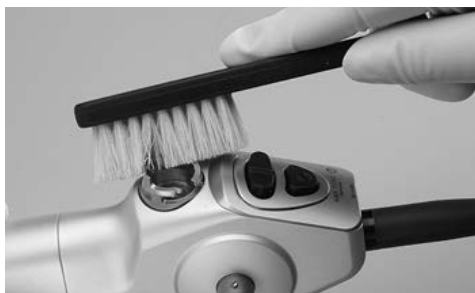
2. Bürsten des Ventilsitz.
