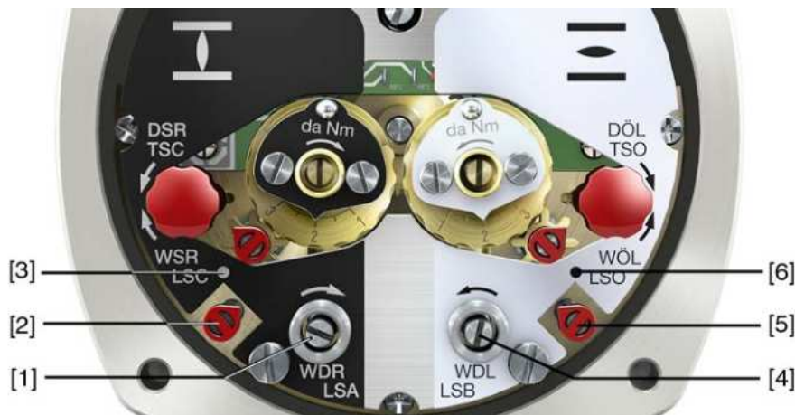
Figura 41: Elemente de setare pentru comutarea limită
