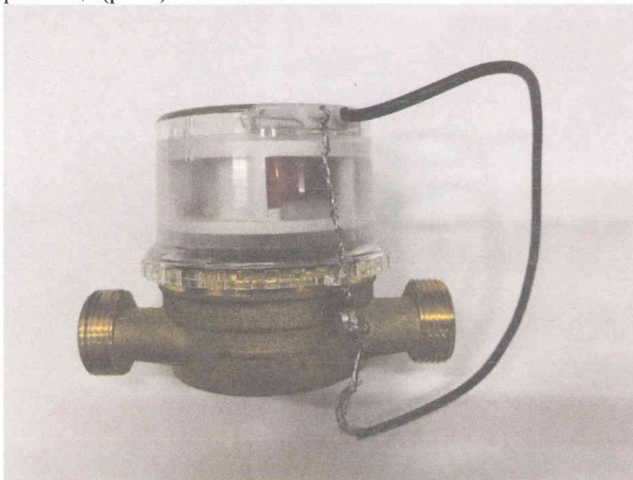
Рисунок 6 – Приклад пломбування імпульсного перетворювача
