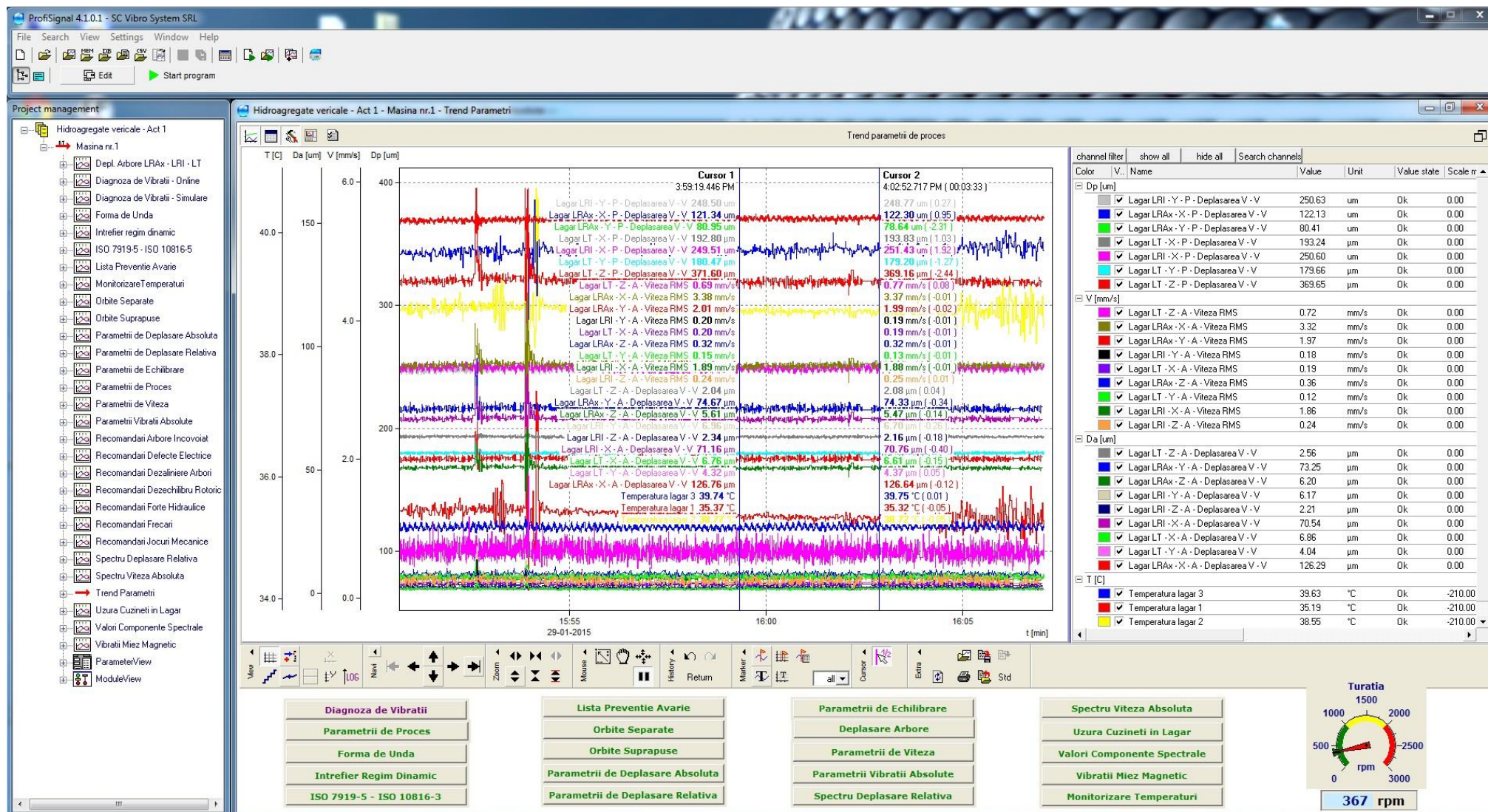
Figura 23. Interfața de urmărire a parametrilor de proces în funcție de timp – Trend cu cursori
