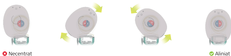
Fig. 10 Alinierea procesorului audio și magneților implantului. Rețineți că microfonul este orientat în sus.
