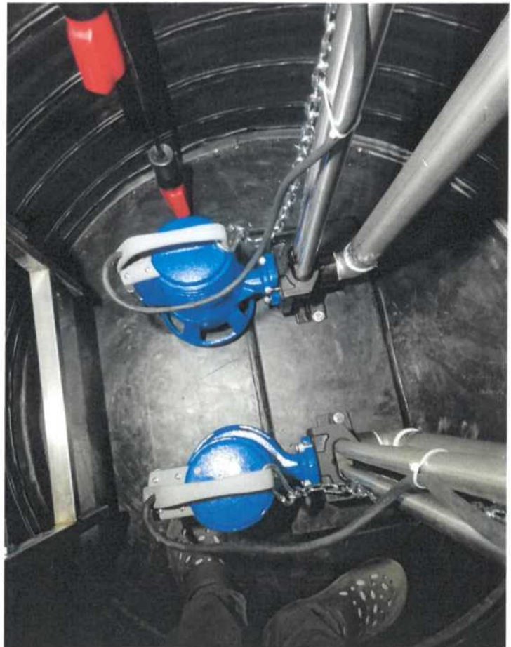
Figura 3: Specimen de încercare - pompe și țevă de refulare din oțel inoxidabil
