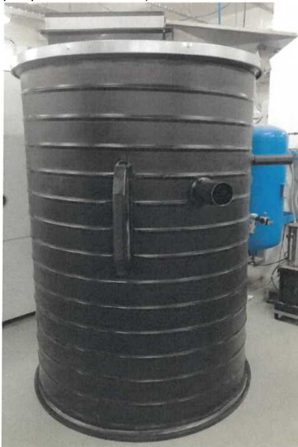
Figura 2: Specimen de încercare - rezervor cu ax de intrare
