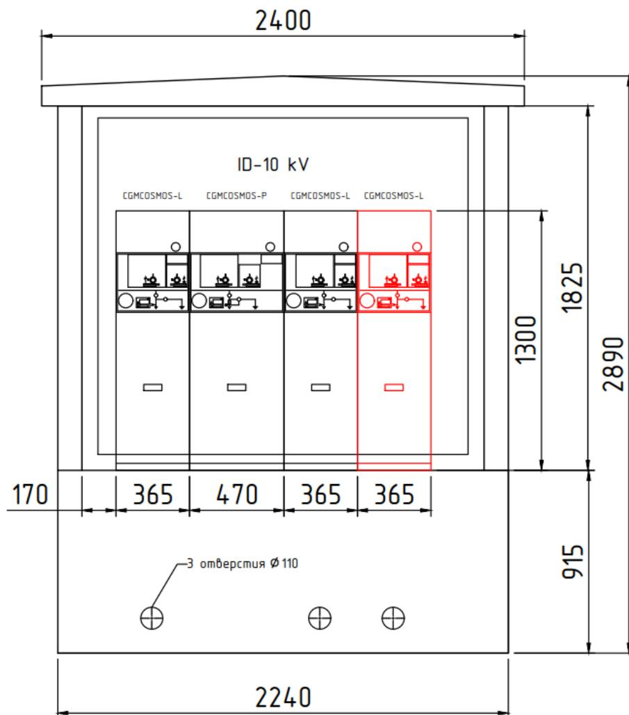
Образец размещения отверстий в фундаментном блоке \*
