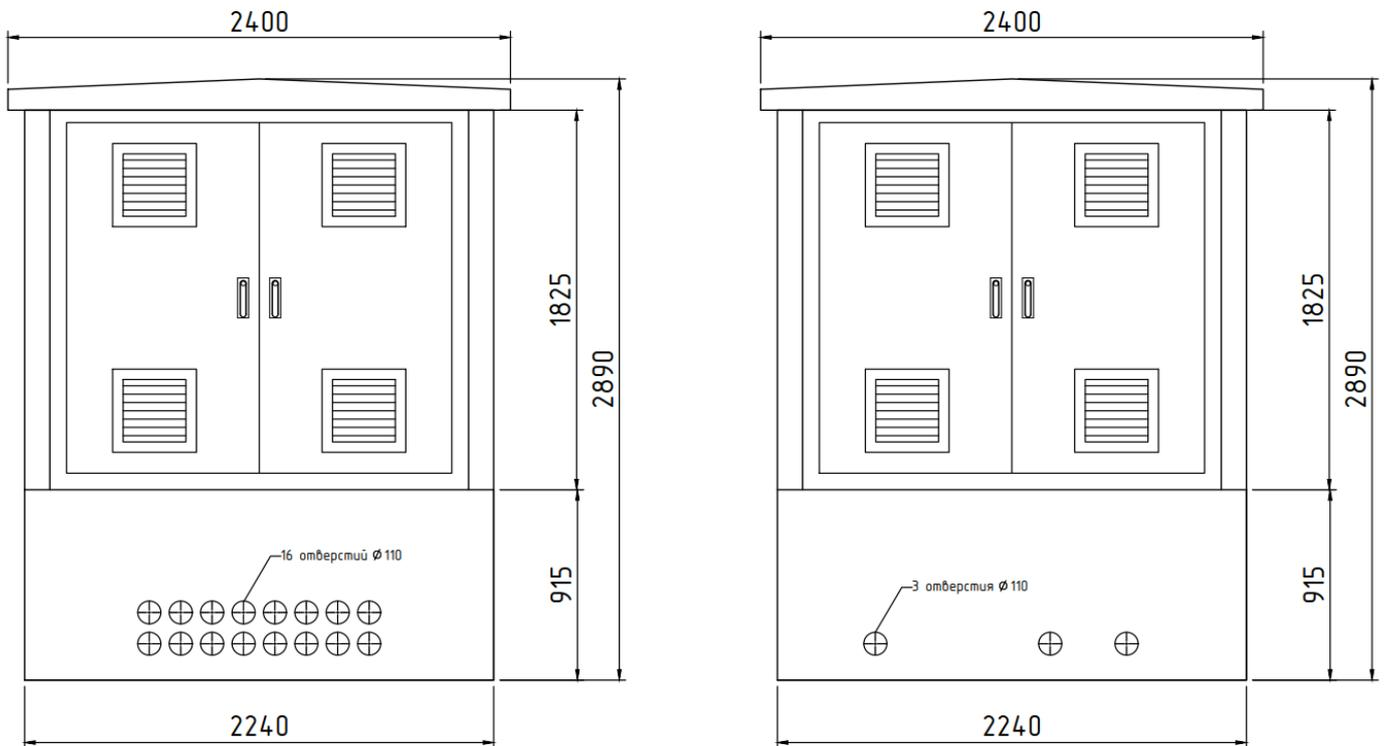
*Количество отверстий в фундаментном блоке и их диаметр и размещение **дополнительно** согласовывается на этапе запуска в работу*
